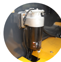
Separador óleo-água do lado externo de fácil verificação e manutenção
