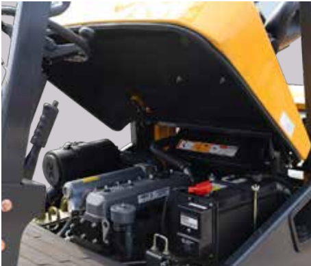
Capô vedado • Capô do motor instalado com fixadores ocultos • A faixa de borracha na parte traseira do capô do motor mantém o compartimento sempre vedado, impedindo a entrada de objetos estranhos no compartimento do motor
