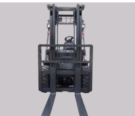
Mastro super estável • Cilindro de inclinação: suporte em posição elevada e maior estabilidade • Mastro com grande sobreposição: menor deformação sob cargas pesadas • Rolamento lateral padrão • Mastro opcional de até 6,0 m • Rolamentos espaçados no carro para menor vibração
