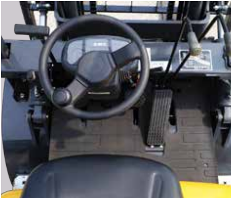
Ergonomia • Volante de 300 mm: menor esforço e maior conforto para o operador • Alavancas de câmbio e hidráulica com layout otimizado
