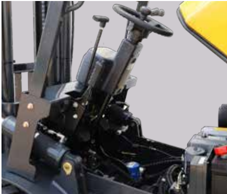
Coluna de direção integral • A coluna de direção conecta-se diretamente à caixa de direção, reduzindo o esforço do operador • Coluna de direção selada, resistente à poeira, água e corrosão
